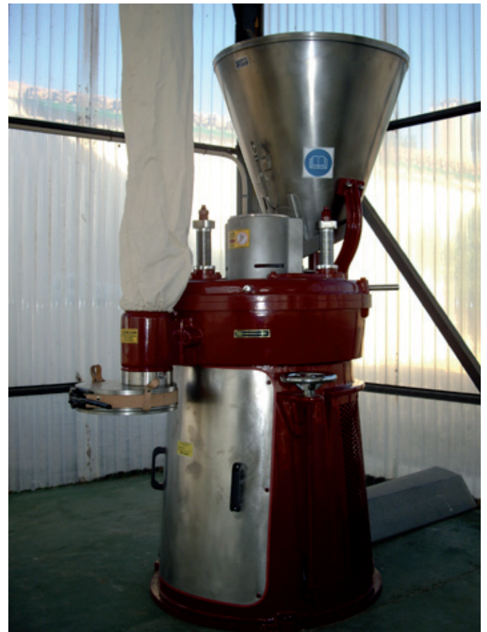
Molino de piedra para producciones locales. Finca experimental Sa Canova, Sa Pobla.
